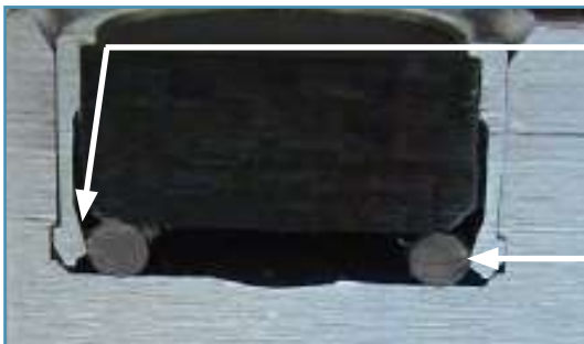
Hülse klemmt form- und kraftschlüssig in der Werkzeugaufnahme Sleeve is clamped by form and press fit into the tool holder
