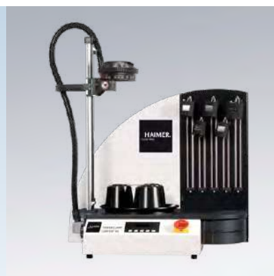
Power Clamp Profi Plus NG Hochleistungs-Schrumpfergerät – Schrumpfleistung 20 kW – Zum Schrumpfen von Werkzeugen mit Ø 3–50 mm – Für HSS- und HM-Werkzeuge – Große Spule für Ø 40–50 mm (Optional) – Inkl. Drehteller und Aufnahmehalter – Inkl. Werkzeugablage – Inkl. Schwenkfächer für Zubehör
