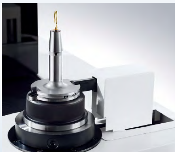
Automatische Positionierung des Schreib-/Lesekopfes Automatic positioning of the read/write head
