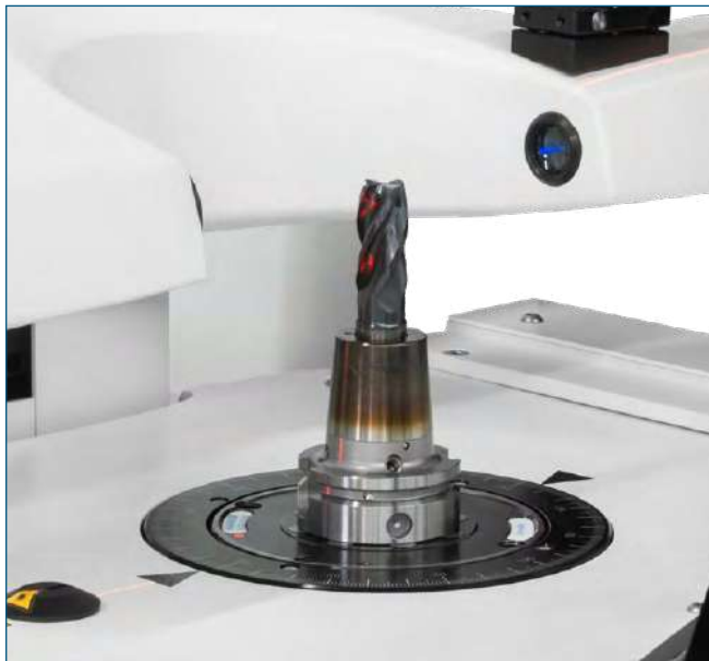
Berührungsloses Messen mit hochauflösender Kamera und digitaler Bildverarbeitung, incl. Messsoftware „Microvision“
